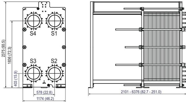
Die Anzahl der Spannbolzen kann je nach Druckauslegung variieren.
