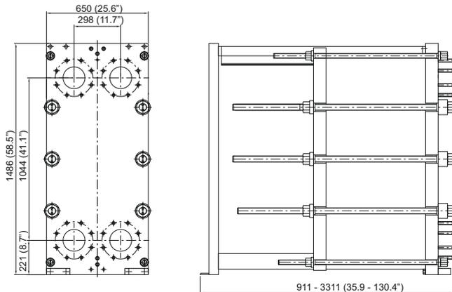
Die Anzahl der Spannbolzen kann je nach Druckauslegung variieren.
