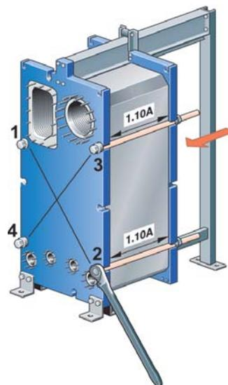
Schritt 2: Danach werden die Bolzen abwechselnd und diagonal angezogen (siehe unten stehende Abbildungen). Position der verwendeten Bolzen beim Anziehen auf Maß A überprüfen.
