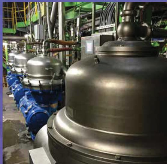
Der Alfa Laval Skimmer ermöglicht es Westward Seafoods, den Ölgehalt im Leimwasser auf unter 0,5 % zu senken.
